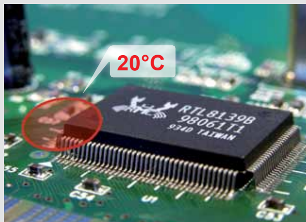
Zbyt duży rozmiar pola widzenia skutkuje błędem pomiaru
